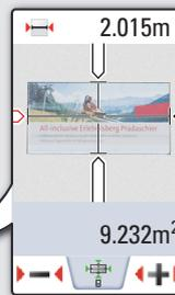
Pfeile mit den Cursortasten oder durch Antippen des Displays auswählen und mit den Softkeys verschieben. Die entsprechende Fläche wird berechnet.
