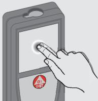
Auf das Display tippen, um eine Schaltfläche auf dem Bildschirm zu öffnen oder eine Auswahl zu treffen. Das Antippen des Symbols in der Mitte der untersten Zeile aktiviert die Distanzmessung oder löst die Kamera aus.
