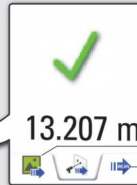
Übertragung der drei Koordinaten x, y, z mittels WLAN
