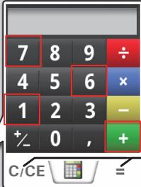
**i** Das Messergebnis aus der Hauptzeile wird in den Rechner übernommen und kann für weitere Berechnungen herangezogen werden. Fuss/Zoll-Brüche werden in Fuss/Zoll-Dezimalwerte umgerechnet. Um ein Ergebnis vom Rechner in den Grundmodus zu übernehmen, vor Verlassen der Rechnerfunktion Taste DIST drücken.
